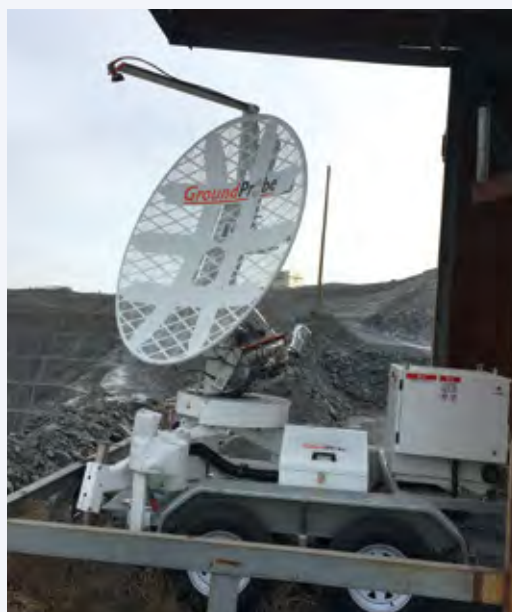
內蒙古太平露天采坑邊坡監控雷達
